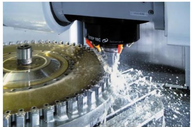
M2: Einsatz von KSS beim Entgratfräsen (Quelle: MTU Aero Engines)
