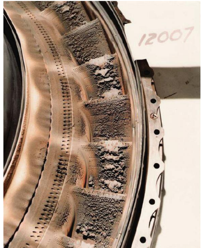
M5: Turbinenschaufeln mit Krusten von Vulkanascheschmelze (Quelle: MTU Aero Engines)
