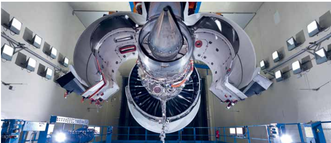
GTF-Triebwerk auf dem Prüfstand ___ Bei der MTU Aero Engines in München finden Endmontage und Serienabnahmeläufe von einem Drittel aller A320neo-Antriebe statt.
